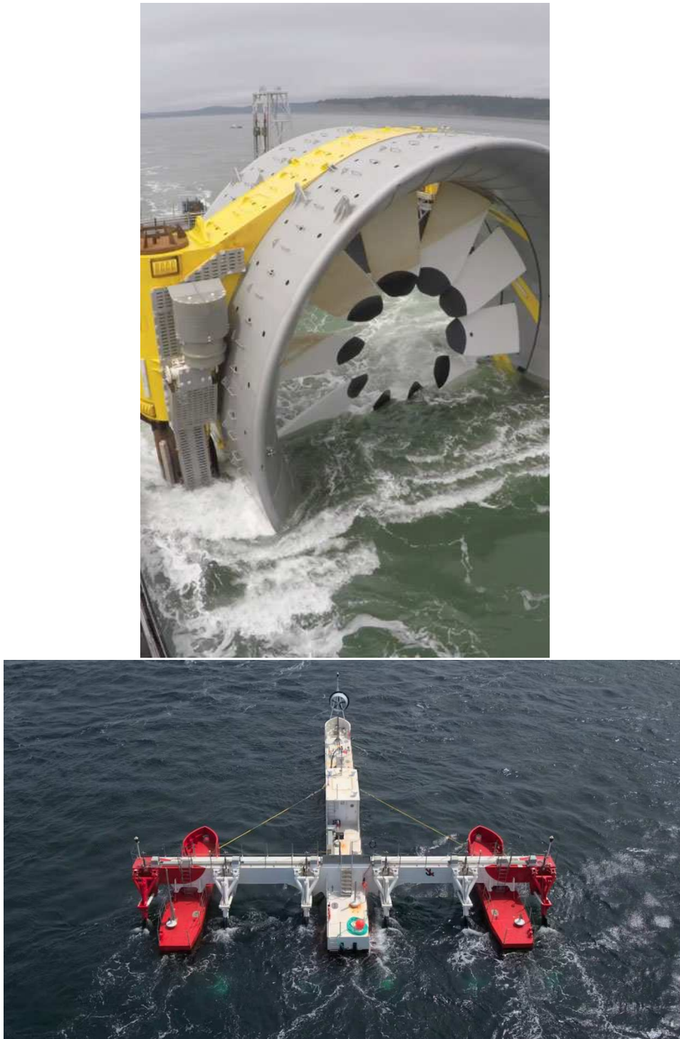
Figure 6.9: Deux designs de turbines marémotrices de surface présentement en phase de développement/test dans la Baie de Fundy. Celle du haut est une turbine monolithique, d'un diamètre de \simeq 15 mètre; celle du bas est composée de six hélices individuelles à trois pales, genre éolienne la tête en bas. Source: https://fundyforce.ca/ .
