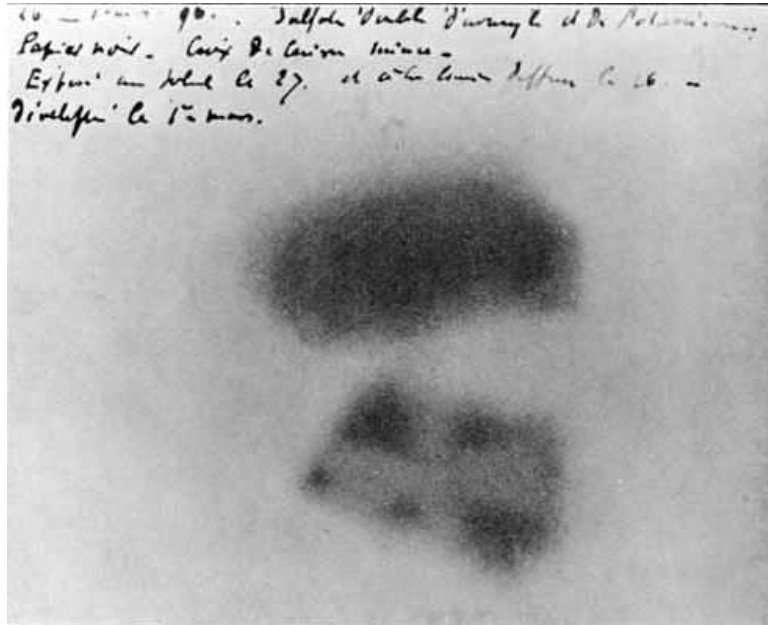
Figure 6.19: Noircissement d'une plaque photographique de Becquerel par deux échantillons de sels d'uranium déposés sur la plaque. Celui du bas avait été déposé sur une croix de Malte métallique ayant protégé partiellement la plaque, produisant une ombre (en négatif) clairement visible ici. Image en domaine public tirée de la page Wikipedia sur Henri Becquerel: https://en.wikipedia.org/wiki/Henri_Becquerel .
