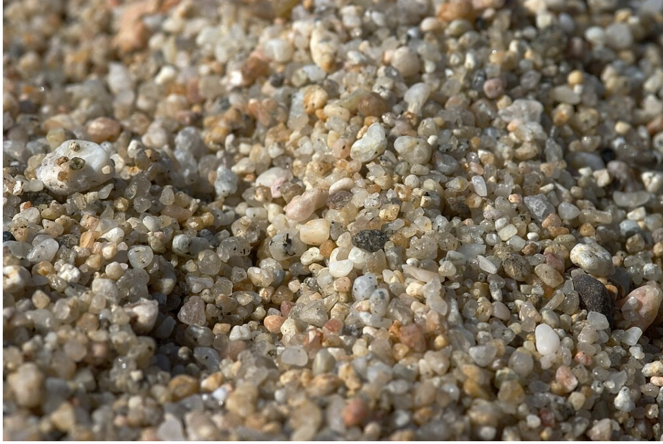
Figure 4.17: Un sable relativement grossier. Les grains, de taille, forme et composition diverses, font contact entre eux typiquement en quelques points, laissant beaucoup de “vide” entre les grains; c’est la porosité, déjà discutée à la §2.3. Source: Wikipedia Commons.
